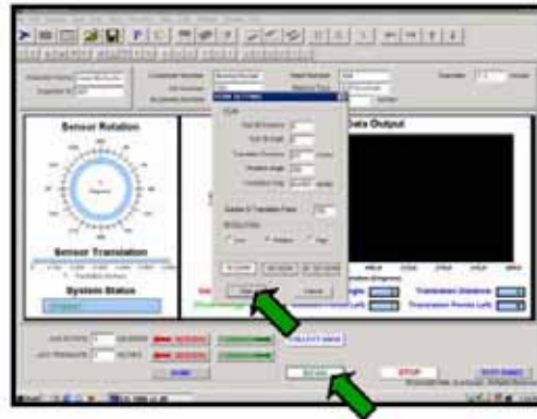
Step 4 Scan をクリックします。スキャン パラメータが表示されたら Start をクリックします。
